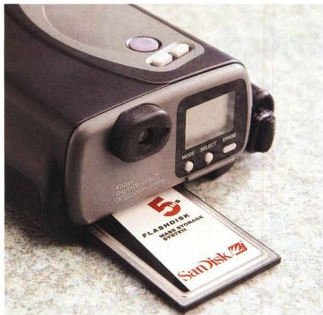
A sinistra la DC50 zoom e la sua predisposizione per schede di memoria PCMCIA a destra il vano pile della DC40. Entrambi gli apparecchi sono alimentati da comuni pile stilo alcaline o analoghe batterie ricaricabili.
